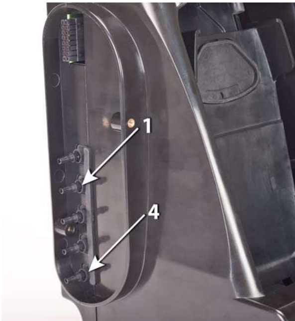
Fig. 17 Entradas de gas en la estación de prueba
