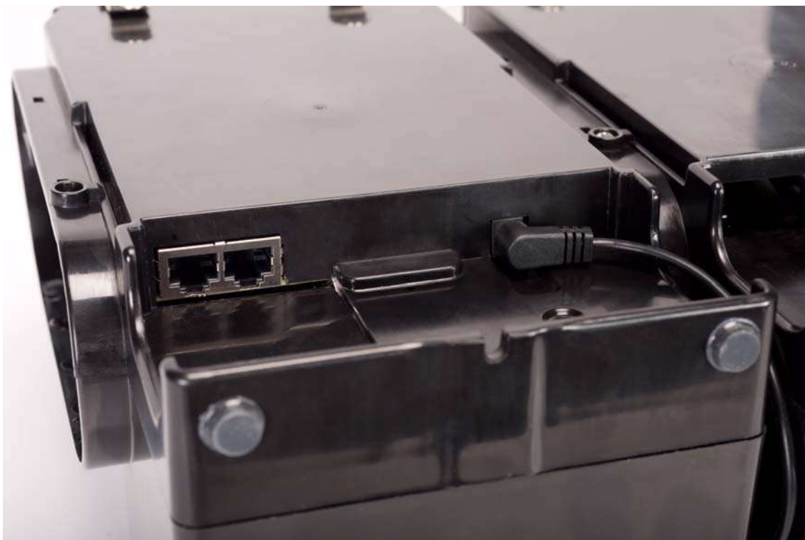
Fig. 6 Conectores Ethernet de la estación de prueba
