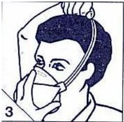
**3.** Acerque el respirador a la cara, acercando primero la parte inferior a la barbilla y de manera que la parte que contiene la espuma se coloque sobre la nariz. Asegúrese de que la solapa inferior esté ajustada y no esté arrugada debajo de la barbilla.
